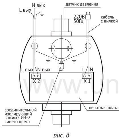
Открутите винты и снимите верхнюю крышку блока управления. Извлеките соединительный изолирующий зажим СИЗ-2. Выполните электроподключение в соответствии со схемой, приведенной на рисунке 8.
